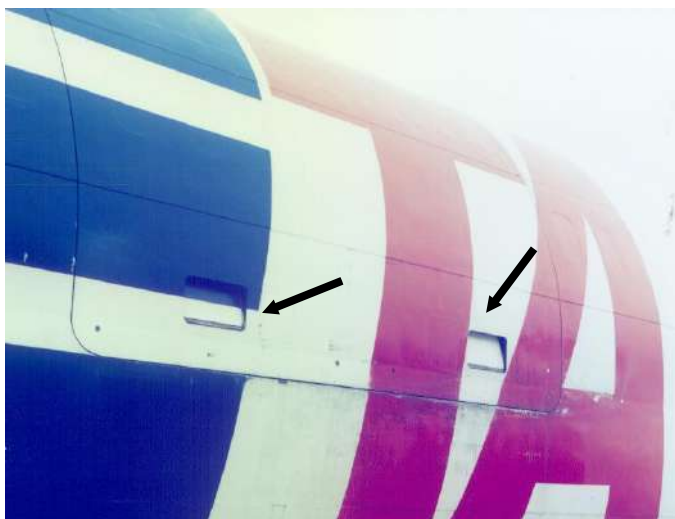
Dispositivo para alívio de pressão da porta de carga de um B 707 Cargueiro
