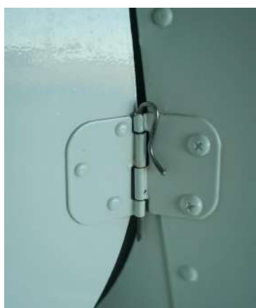
Dispositivo de remoção da porta
