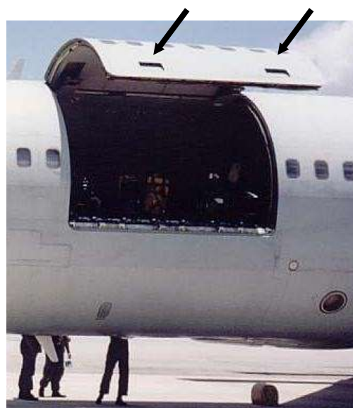
Dispositivo para alívio de pressão da porta de carga de um B 707 Cargueiro
