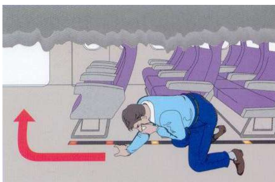
Iluminação de rota de fuga no piso
