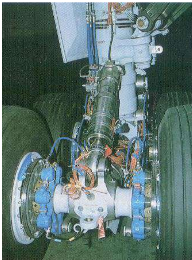
Discos de freio: atrito eleva a temperatura a 260 graus
